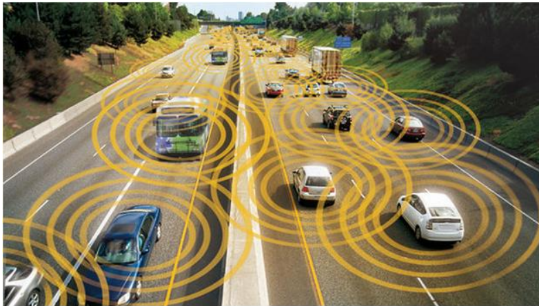
Bei V2X-Kommunikation (Vehicle-to-X) tauschen Fahrzeuge untereinander sowie mit der Straßeninfrastruktur automatisch Informationen aus. - Foto: RITA
